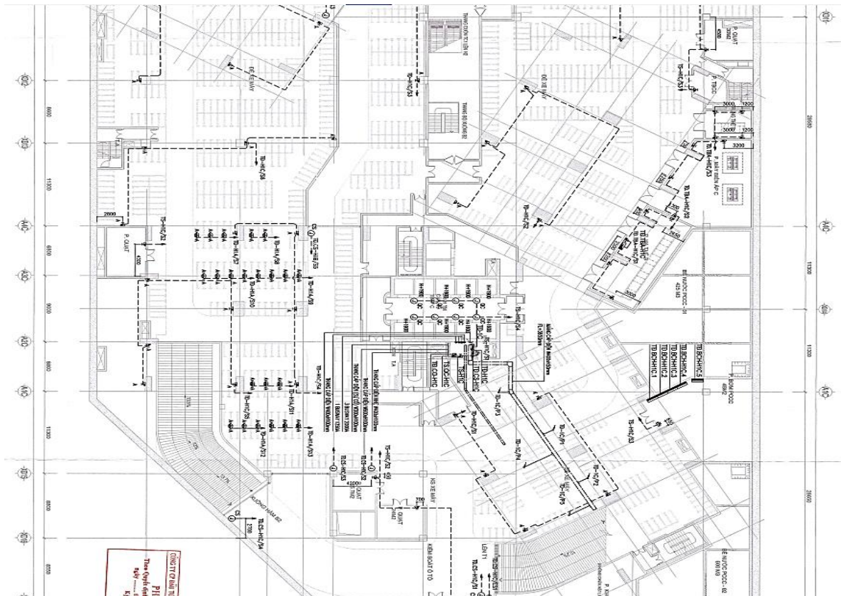
Mặt bằng ô cấm tầng hầm 1
