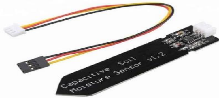
Hình 1.4 Cảm biến độ ẩm đất điện dung
