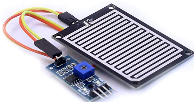
Hình 1.7 Hình ảnh cảm biến mưa
