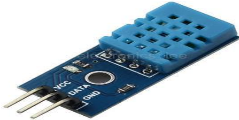
Hình 1.6 Hình ảnh cảm biến DHT11
