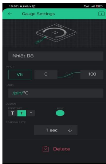
Hình 3.15 Hình ảnh thiết lập giao diện nhiệt độ Nhiệt độ, input là V6 value 0 – 100
