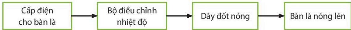
Hình 9.2. Sơ đồ khối mô tả nguyên lí làm việc của bàn là
