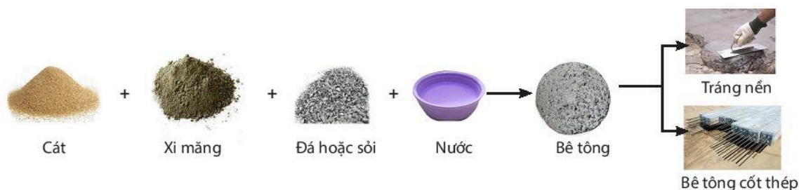
Hình 1.8. Trộn bê tông
