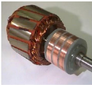
Hình 1.2: Rotor dây quấn và sơ đồ mạch điện của rotor dây quấn
