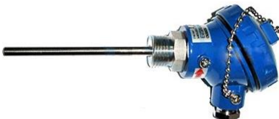
Hình 3. 13Cảm biến nhiệt E52MY-CA10C D6.3MM SUS316 Omron.
