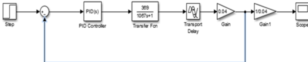
Hình 3. 30.Sơ đồ khối dưới dạng phản hồi (-1)
