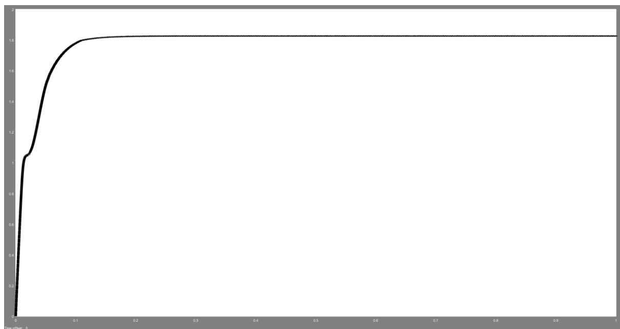
Hình 5.15: Dòng điện ra của tấm pin với thuật toán P&O (1,8A)
