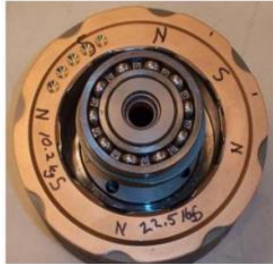
Hình 2.15: Rotor có nam châm gắn trên bề mặt.
