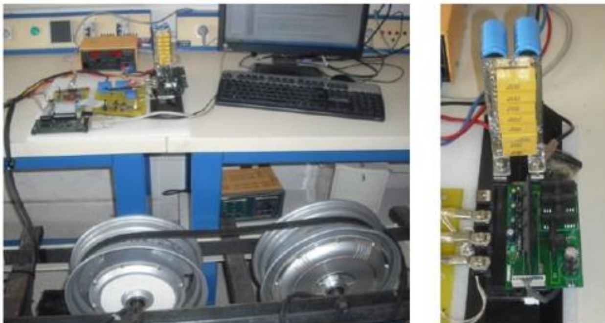
Hình 3.8: Thiết lập thử nghiệm để kiểm tra động cơ truyền động không chổi than trong bánh xe và mạch nguồn dựa trên IPM.
