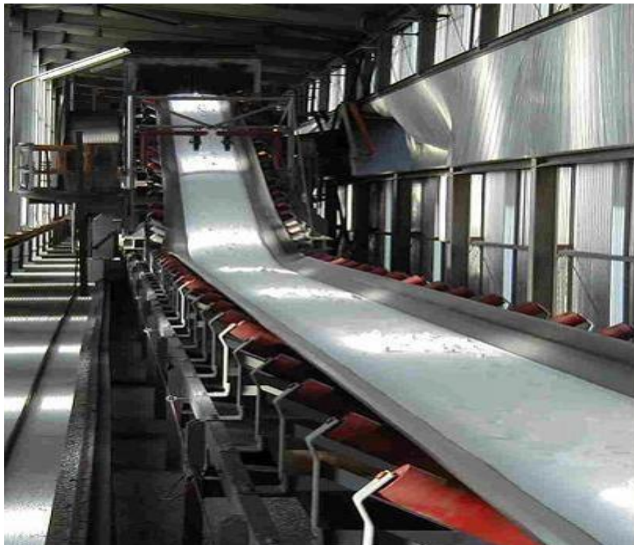
Hình 1.8: Băng tải trong nhà máy xi măng
