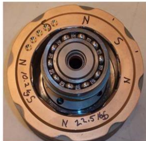
Hình 1.6: Rotor có nam châm gắn trên bề mặt lõi
