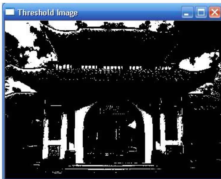
Hình 1-12. Ảnh sau khi phân ngưỡng toàn cục với mức ngưỡng 150
