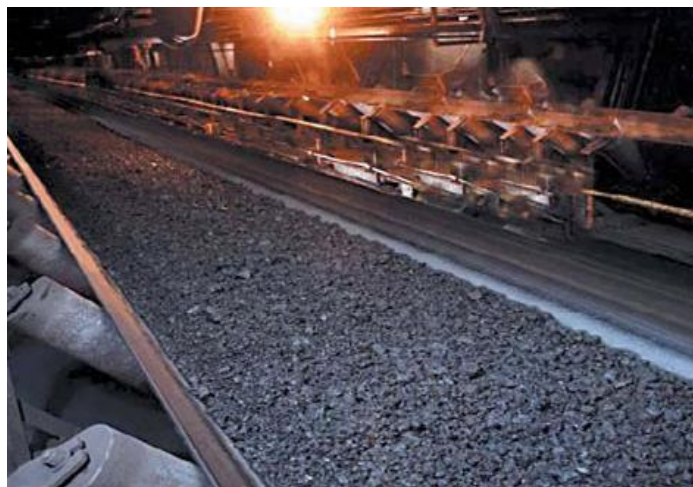
Hình 1.11: Băng tải chịu nhiệt đang vận hành than vào lò nhiệt.
