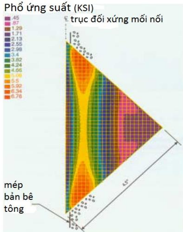
Hình 1. 14 Phân bố ứng suất uốn trên bề mặt thép bản truyền lực dày 6 mm [25]
