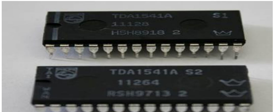
Hình 3.2 IC chuyển đổi DAC TDA1541
