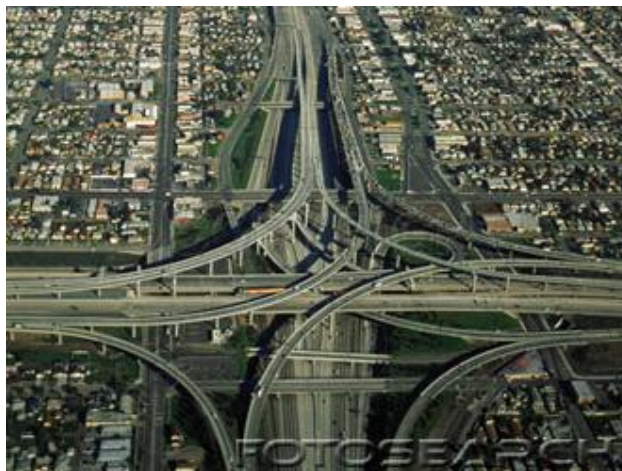
Hình 1.09: Các nút giao nhiều nhánh rẽ trực tiếp [14]
