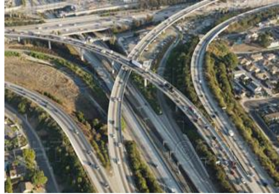
Hình 1.06: Dạng nút giao hình tam giác[14]
