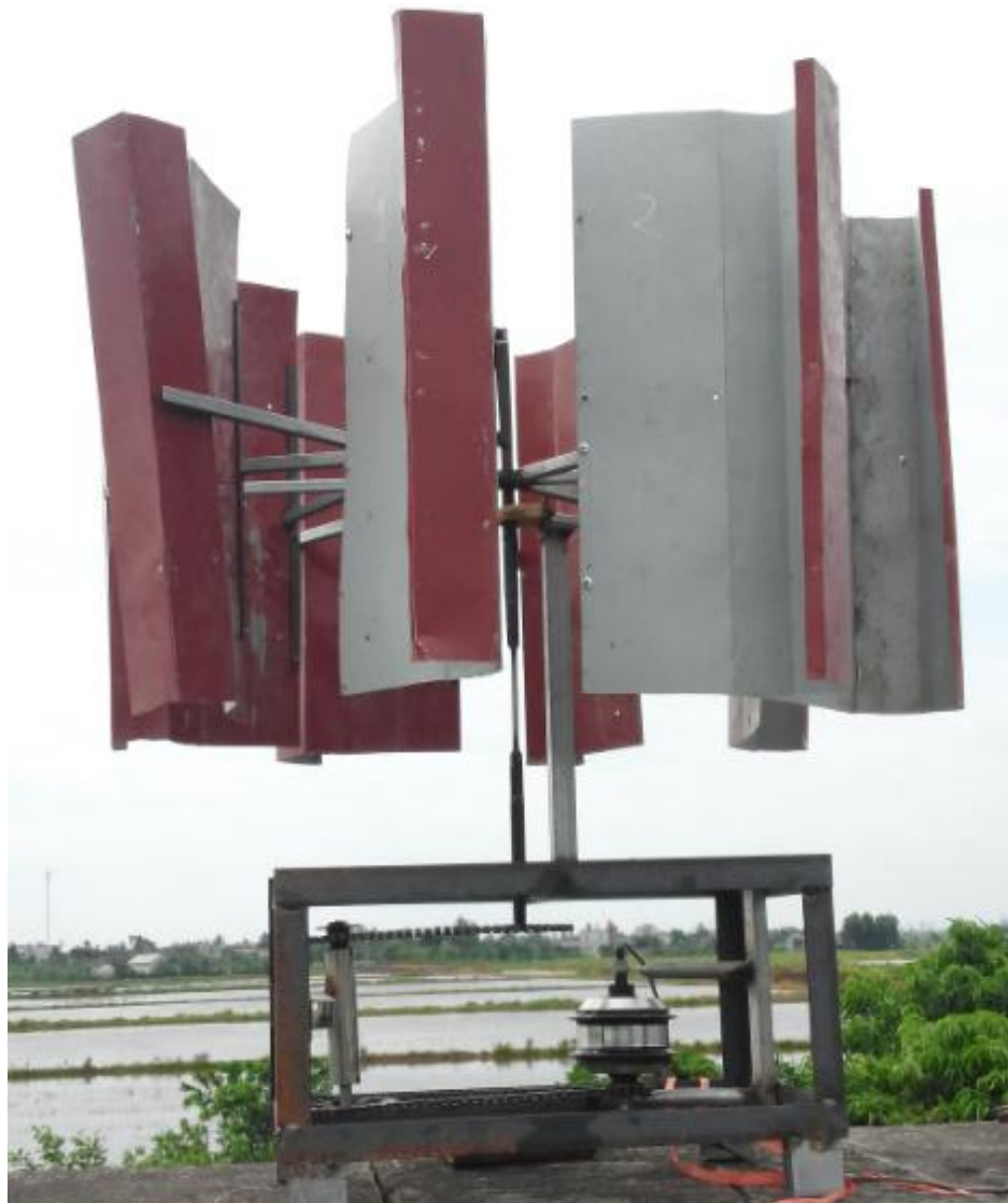
Hình 4.4. Động cơ xe đạp điện dùng làm máy phát cho hệ thống.
