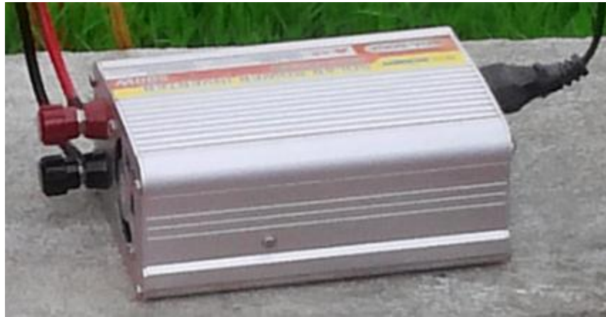
Hình 4.9. Bộ nghịch lưu dùng cho mô hình mô phỏng hệ thống.
