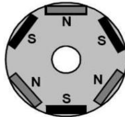
Rotor lõi tròn với nam châm hình chữ nhật được đặt trong rotor
