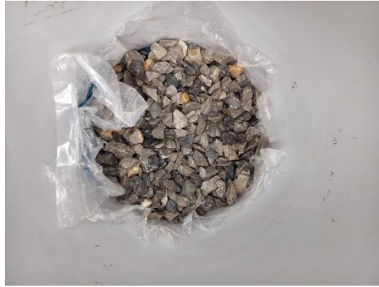
Hình 2.6. Lớp đá trung bình trong chậu xử lý
