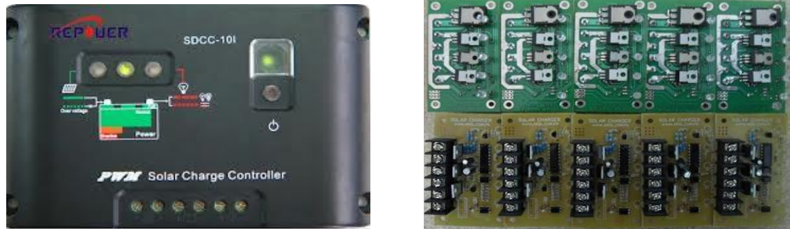
Hình 1.3. Bộ điều khiển sạc cho hệ thống năng lượng mặt trời
