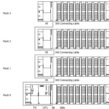
Hình 3.5: Cấu trúc ghép qua module IM
