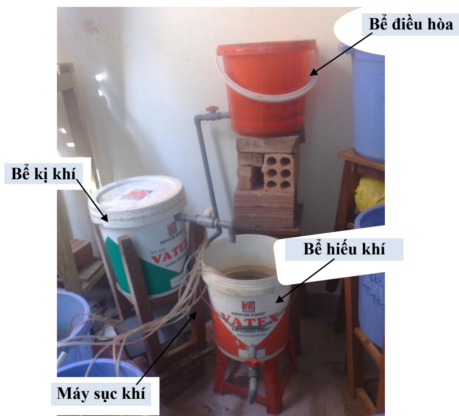
Hình 2.4. Sơ đồ hệ thống xử lý nước rỉ rác bằng phương pháp lọc sinh học kị khí kết hợp hiếu khí
