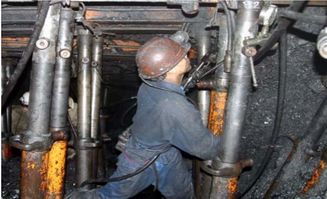
Hình 1.1 Kiểm tra cột chống thủy lực trong lò chợ
