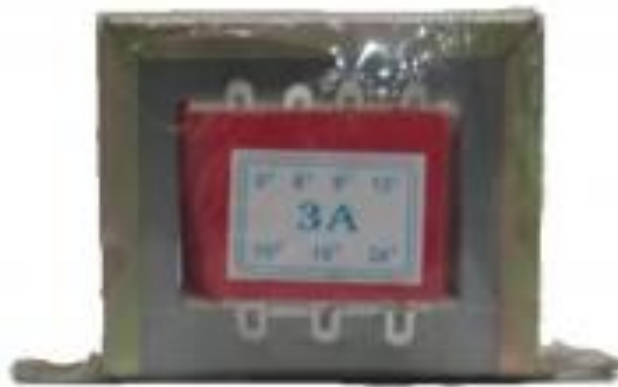
Hình 3.4 : Biến áp KDK 3A
