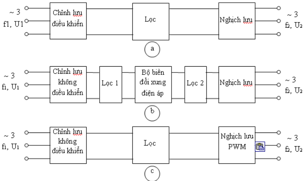
Hình 2.1. Bộ biến tần gián tiếp có khâu trung gian một chiều
