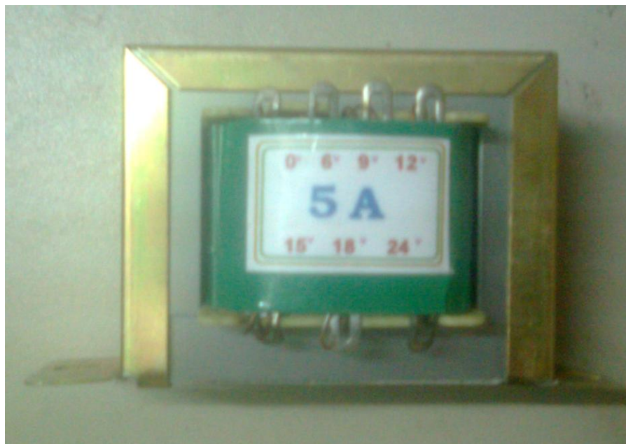
Hình 3.6: Biến áp 5A
