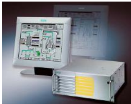
Hình 1.3: Trạm vận hành trong PCS7.
