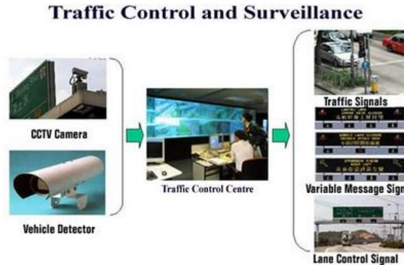
Hình 1.1. Hệ thống ITS Hong Kong sử dụng hệ thống CCTV và các cảm biến để thu thập thông tin.
