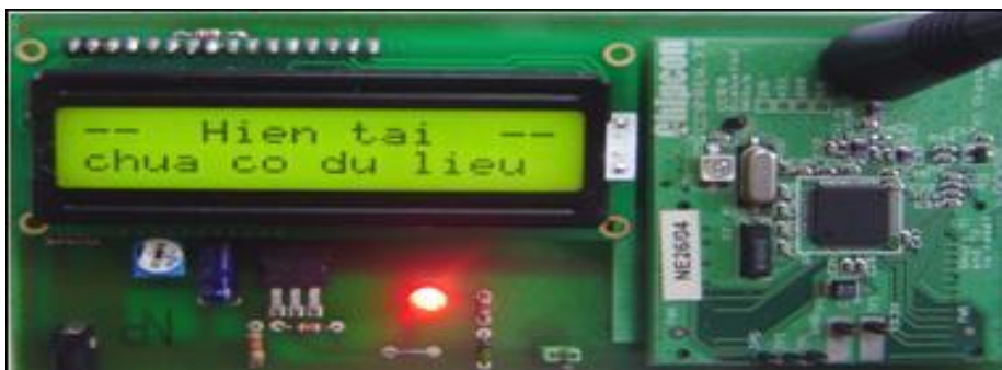
Hình 3-19 Kết quả kiểm tra nút số 1 khi nút gốc chưa hoạt động
