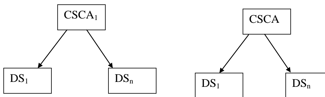
Hình 3.2: Mô hình tổ chức phân cấp CA phục vụ quá trình Passive Authentication
