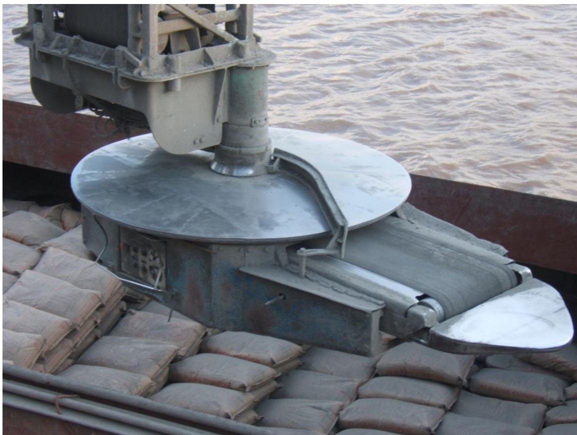
Hình 2.5. Ảnh chụp băng tải T4 và bàn quay
