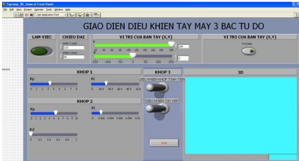
Hình 2.41: Giao diện điều khiển robot ở chế độ tự động từ máy tính
