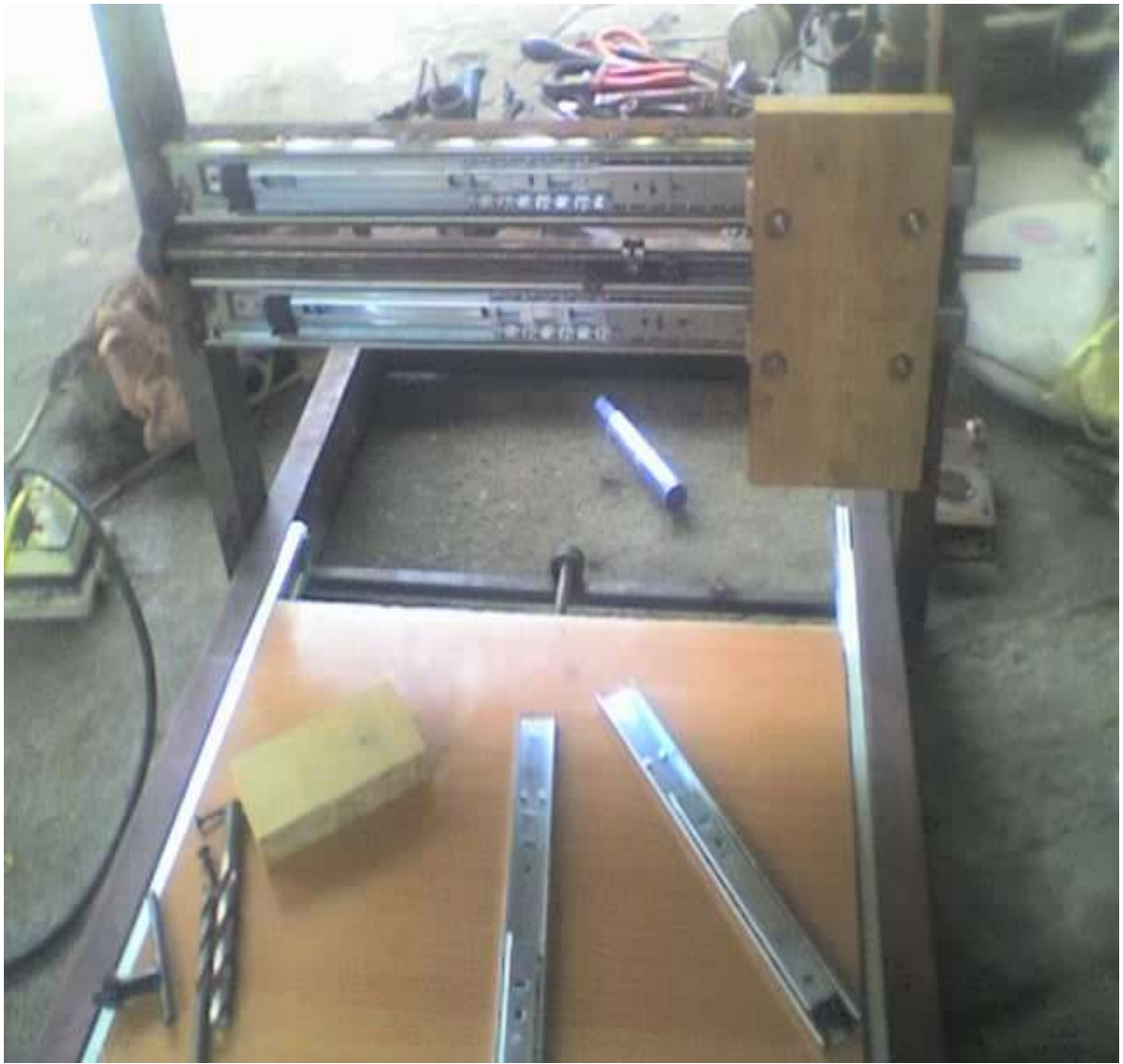
Hình 3.2. Chế tạo trục Y bằng gỗ
