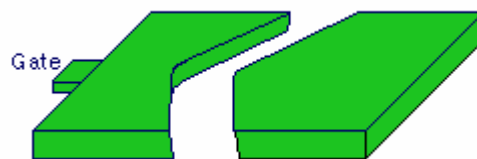
Hình 3.3: Sản phẩm bị gãy.
