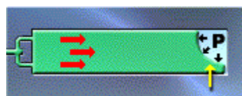
Hình 3.17: áp ngược do khí không thoát được ra ngoài
