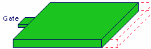
Hình 3.8: Sản phẩm bị hụt.
