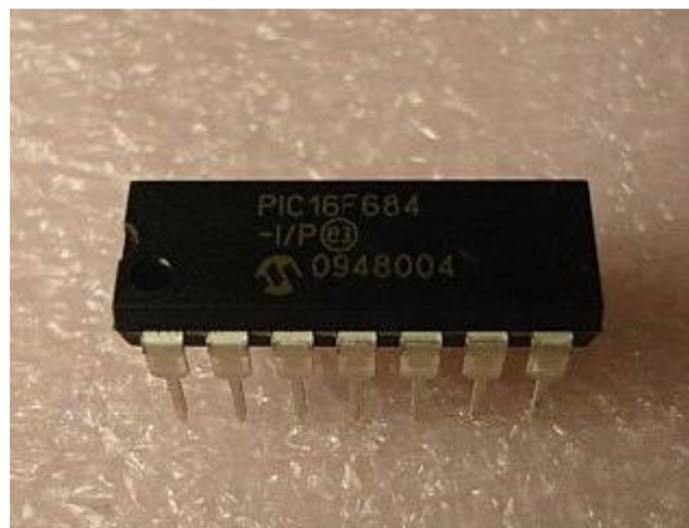
Hình 3.6. Hình dạng thực tế Pic 16F684
