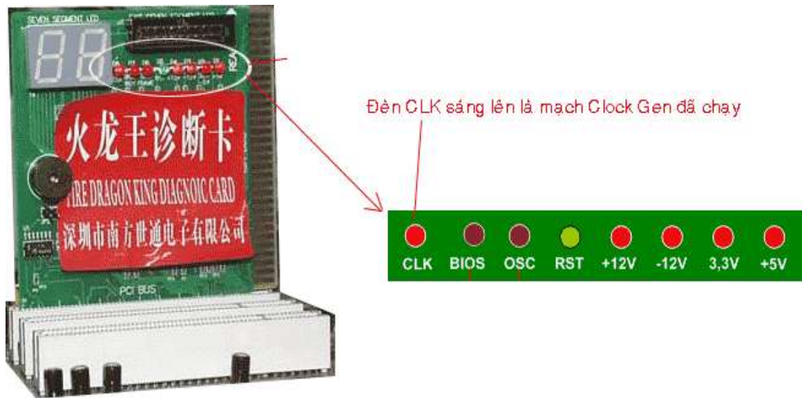
Hình 3.8. Dùng card test main kiểm tra xung clock
