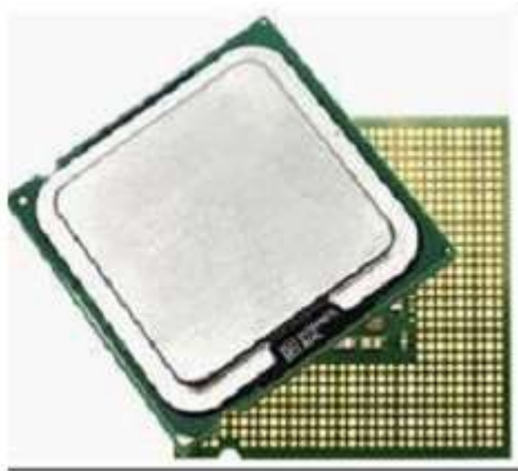
Hình 1.5 CPU Pentium 4 sản xuất năm 2006 với tốc độ 3.2GHz
