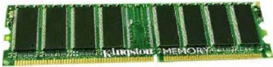
Hình 1.9 Hình dạng bên ngoài của RAM
