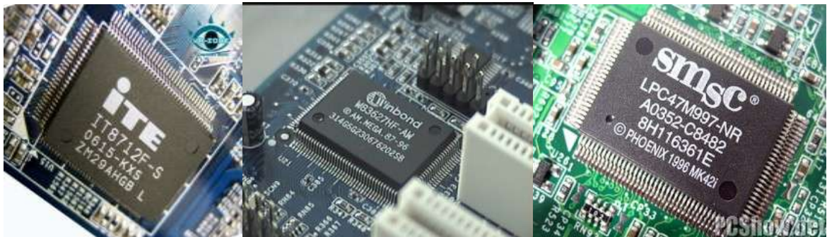
Hình 2.10 Chip Super I/O được gắn trên Main
