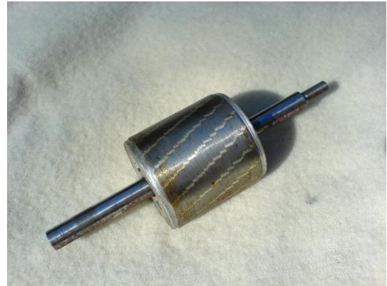
Hình 2.1.2.2 Rô to động cơ không đồng bộ roto lồng sóc
