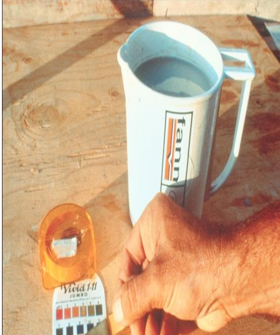
KIỂM TRA DUNG TRỌNG Bùn khoan TRƯỚC KHI CHO LỒNG THÉP XUỐNG Hố khoan VÀ ĐỔ BÊ TÔNG
