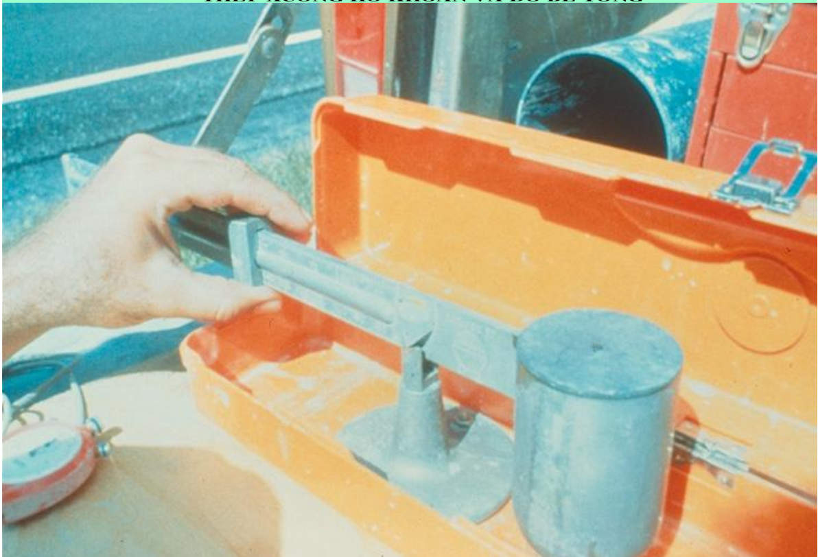
KIỂM TRA DUNG TRỌNG Bùn khoan TRƯỚC KHI CHO LỒNG THÉP XUỐNG Hố khoan VÀ ĐỔ BÊ TÔNG
