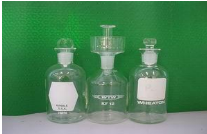
Hình 1.4. Các chai BOD được sử dụng trong phương pháp chuẩn độ và điện cực
