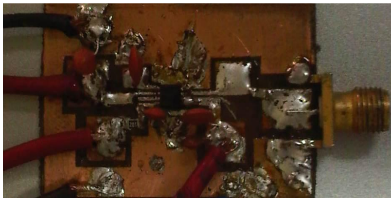
Hình 4.10: Ảnh chụp mạch thật của bộ dao động VCO - MAX 2750.
