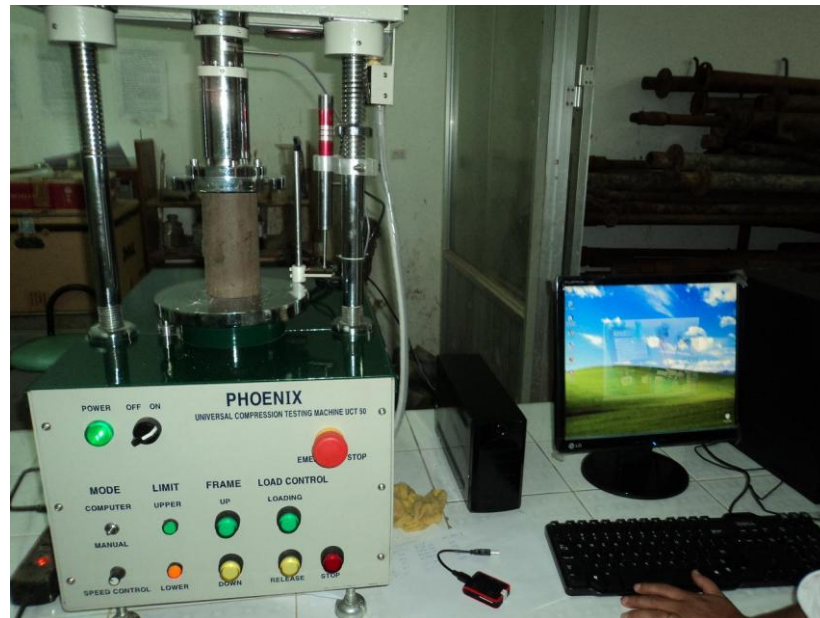
Nén mẫu gia cố bằng máy nén một trục Phoenix
