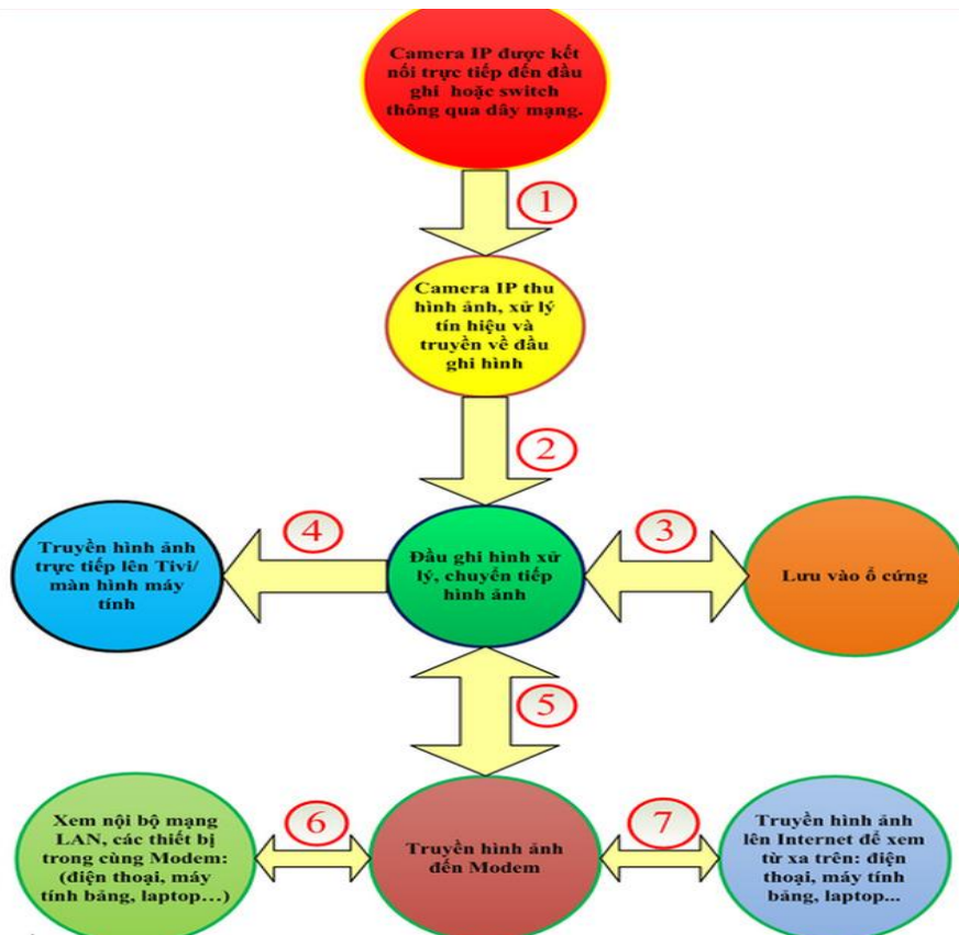
Hình 2.2 Nguyên lý hoạt động hệ thống Camera IP
