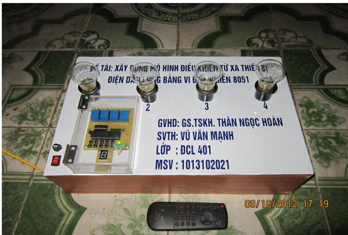
Hình 2.13: Mô hình thực hệ thống điều khiển.
