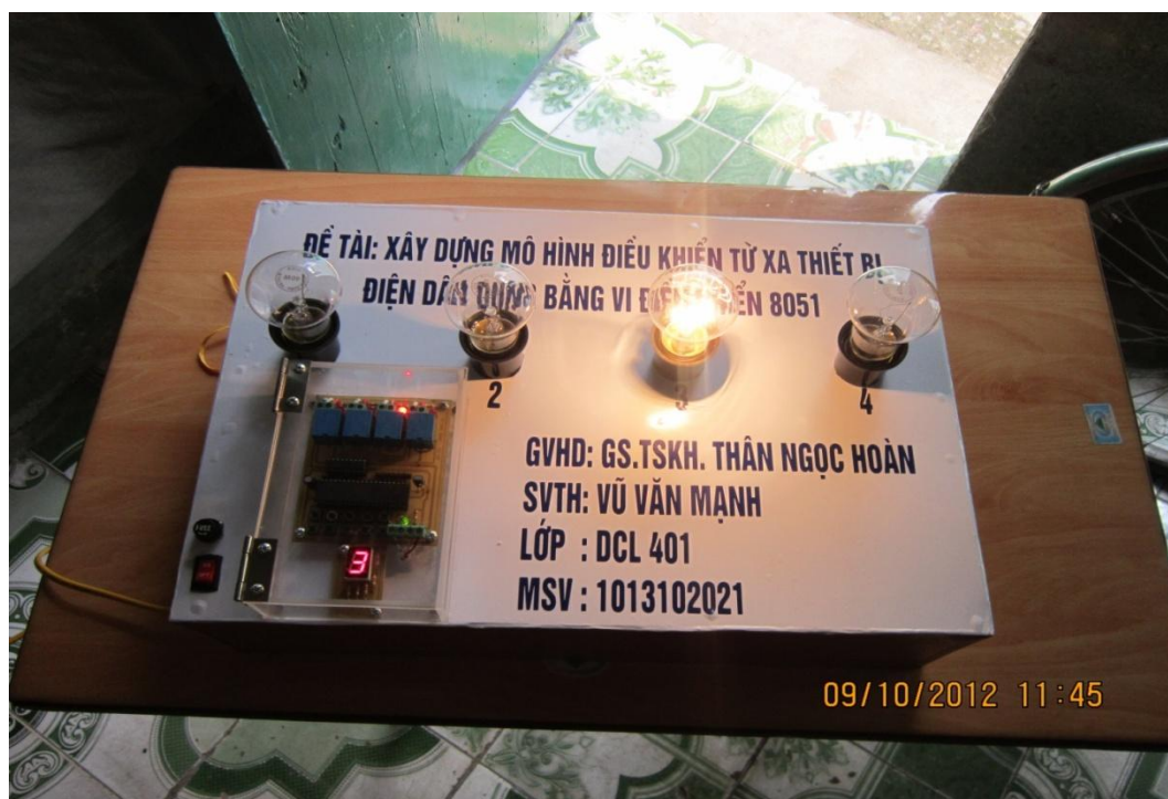
Hình 2.19: Điều khiển bật thiết bị 3.
