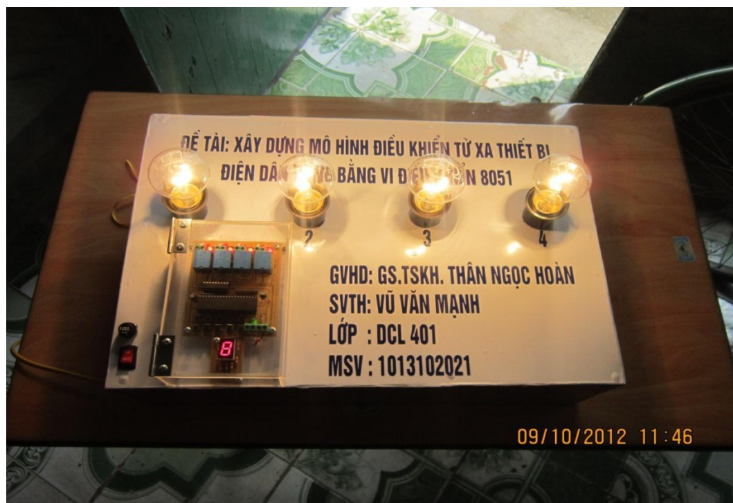
Hình 2.21: Điều khiển bật 4 thiết bị.
