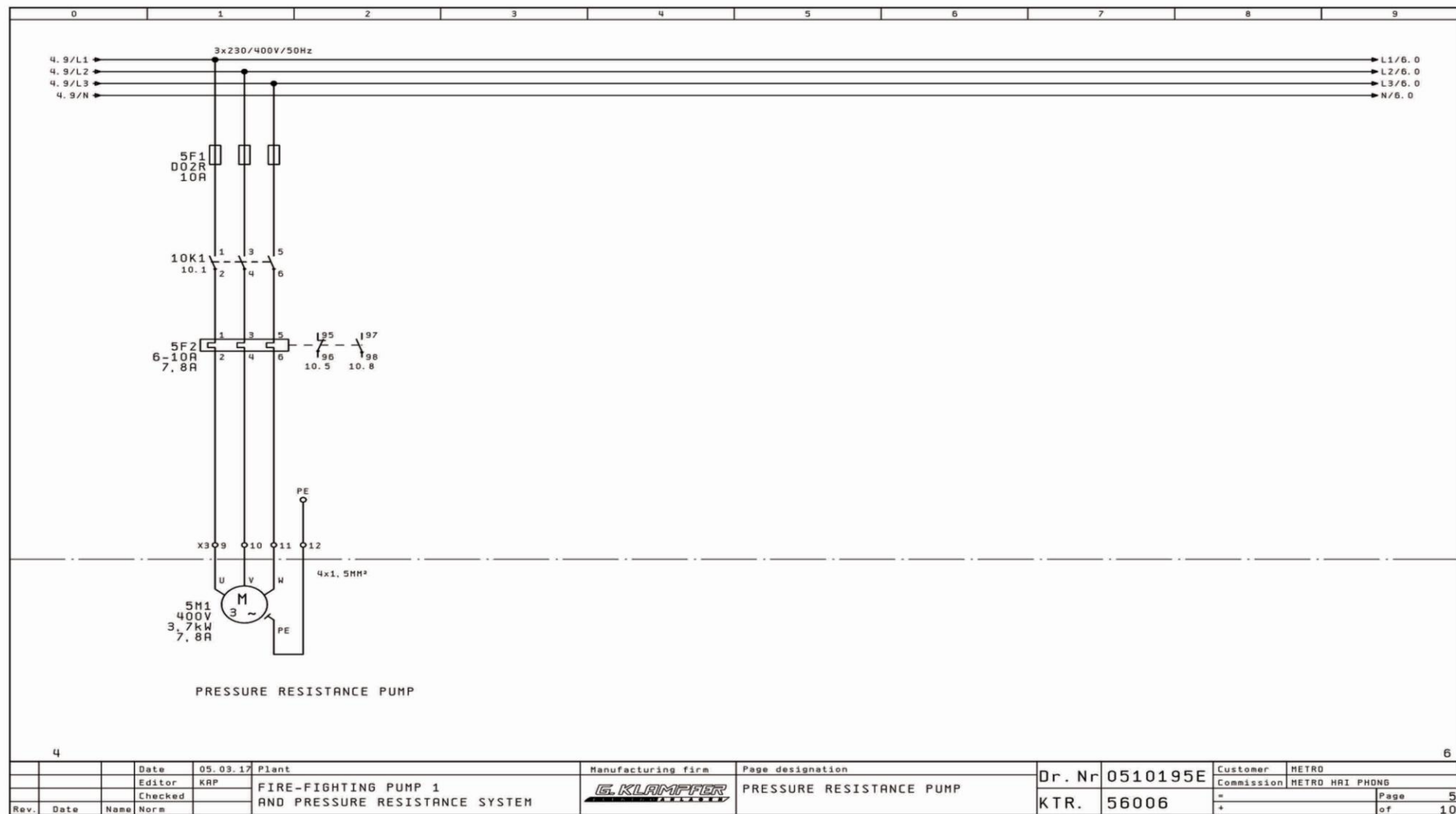
Hình 3.9. Mạch động lực động cơ lai bơm bù áp
