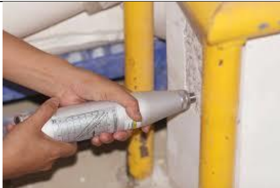
Hình 31. Thao tác sử dụng súng thử cường độ bê tông Schmidt
