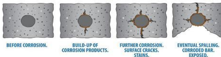
Hình 11. Quá trình phát triển của vết nứt dẫn tới phá vỡ hoàn toàn sự kết dính giữa bê tông và cốt thép
