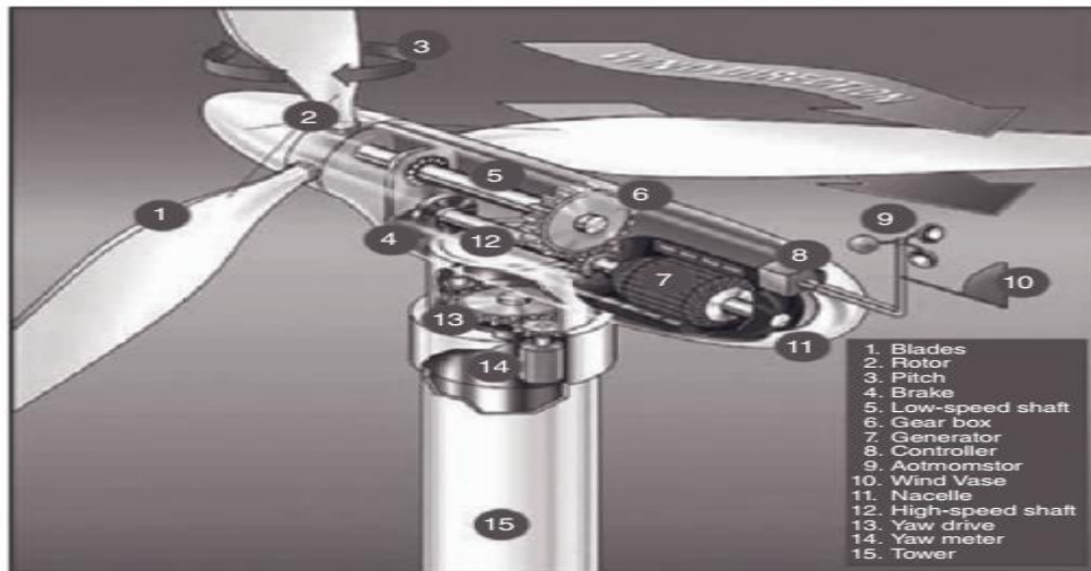
Hình 2.4 Hệ thống tuabin gió (Ảnh từ phòng thí nghiệm Năng lượng tái tạo quốc gia)
