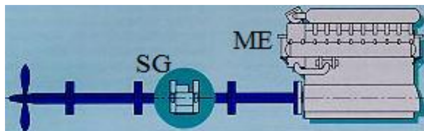
Hình 1.2: Máy phát đồng trục là một phần của trục chân vịt
