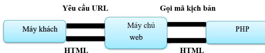
Hình 1.2: Sơ đồ hoạt động của PHP
