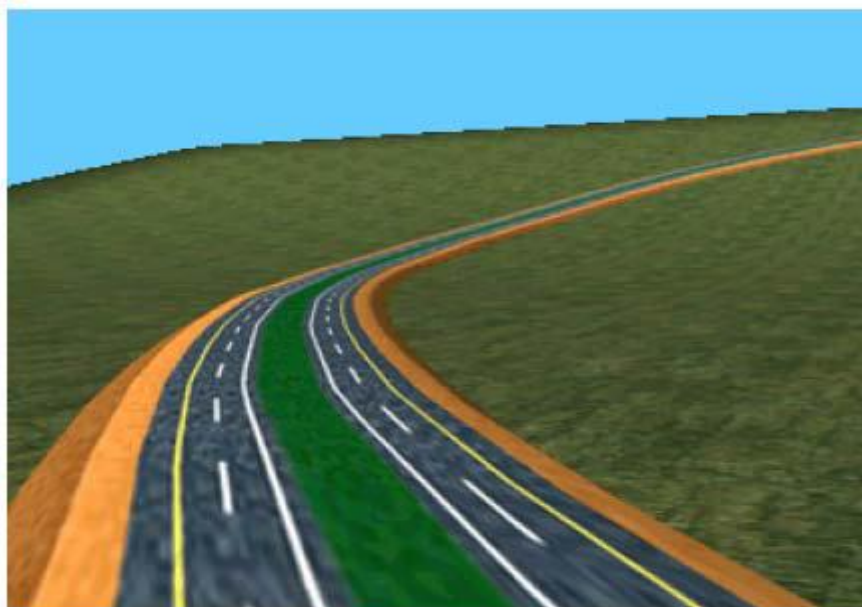
Hình 27a. Đoạn chêm ngắn nằm giữa hai đường cong cùng chiều có gây hiệu ứng "gãy ở lưng"
