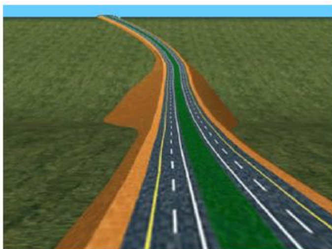
B. Đường cong đứng lồi lõm có chiều dài lớn nối tiếp vào đường cong bằng
