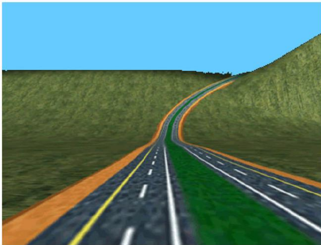
Hình 36 Sự phối hợp không tốt giữa đường cong đứng và đường cong nằm
