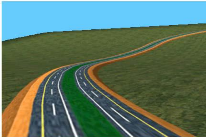
Hình 27a. Đoạn chêm ngắn nằm giữa hai đường cong cùng chiều có gây hiệu ứng "gãy ở lưng"
