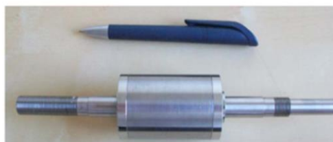
Hình 1.7: Rôto và stato của động cơ tốc độ cao.
