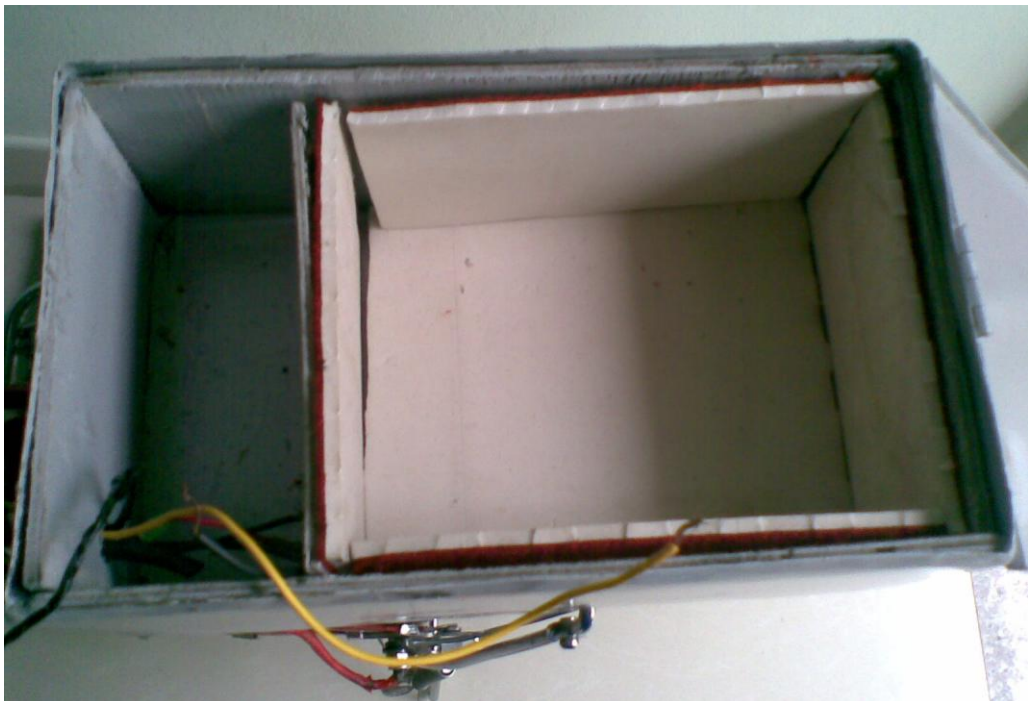
Hình 3.12: Lót gỗ và mút trong hộp điện.
