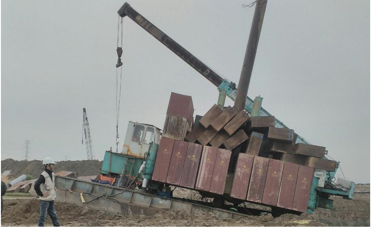
Hình 2.4.1 Máy bị lún nghiêng do mặt bằng yếu
