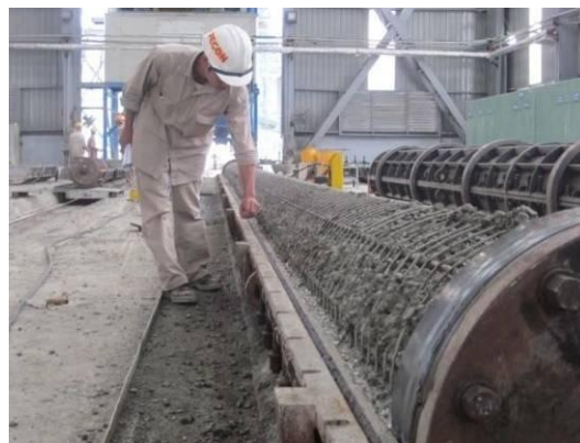
Hình 2.12 Kiểm tra bê tông
