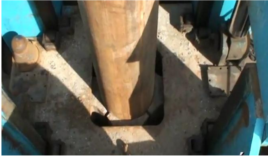
Hình 2.23 Bộ phận kẹp giữ và ép cọc của Robot
