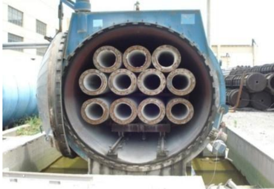
Hình 2.18 Bể bảo dưỡng cọc bê tông
