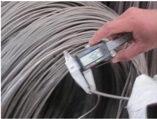
Hình 2.2 Kiểm tra đường kính thép đai
